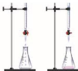
Hình 2.6. Chuẩn độ dung dịch \text{NaOH} bằng dung dịch \text{HCl}
